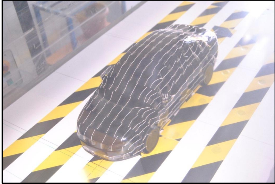
Şekil 4.2 “1:10” ölçekli model UURT iplikcik testi
