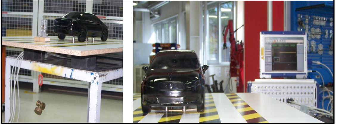
Şekil 3.30 “1:10” model strain gauge balans sistemi
