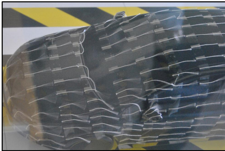
Şekil 4.111 1:10 model 'L1 -T1' konumunda arkadaki araç iplikcik testi ( U_{\infty} = 30 m/s)
