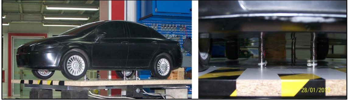
Şekil 3.23 “1:5” model straingaugedance balans düzeni
