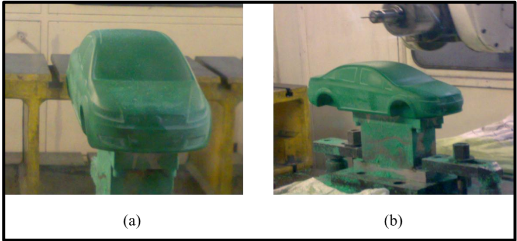
Şekil 3.11 “1:10” modelin 5 eksenli tezgahta işlenmesi
