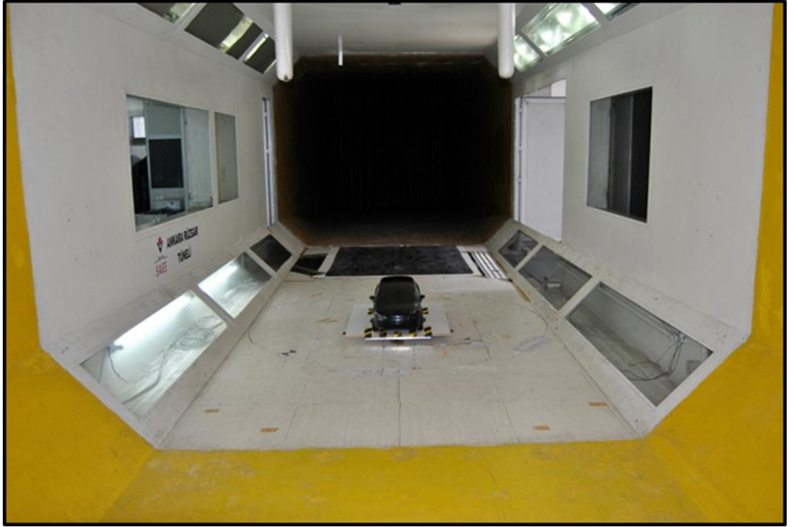
Şekil 3.37 “1:5” model ART tünel deney odası yerleşimi
