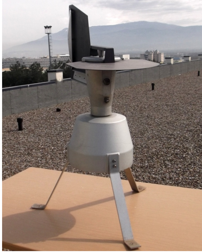
Şekil 3.1.1. Çalışmada kullanılan polen ve partikül toplama cihazı
