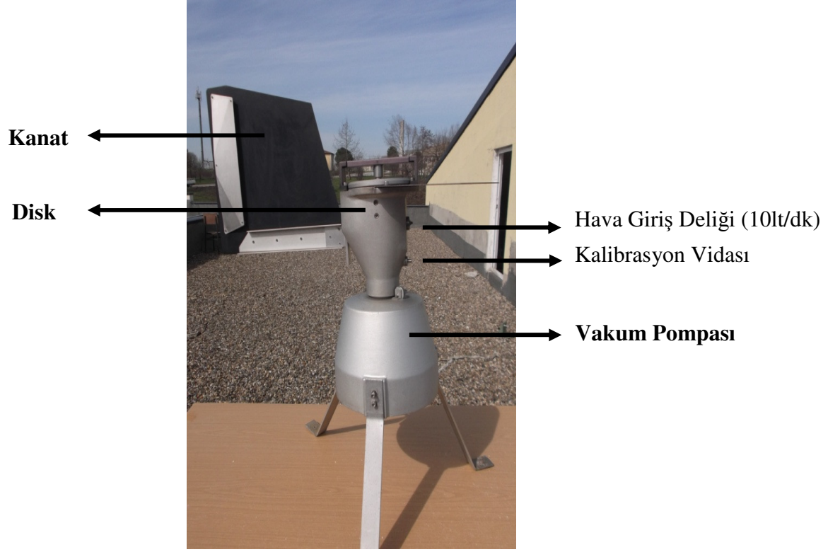
Şekil 3.2.1. Lanzoni marka VPPS 2000 cihazının temel üniteleri
