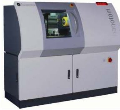
Şekil 3.5. JRC-IET'deki X ışınları Bilgisayarlı tomografi cihazı
