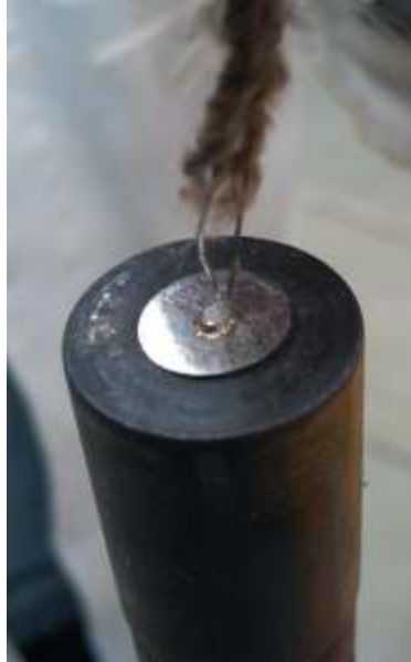
Şekil 3.11. SP diskinin üst merkezine nokta kaynağıyla sabitlenen termokupl
