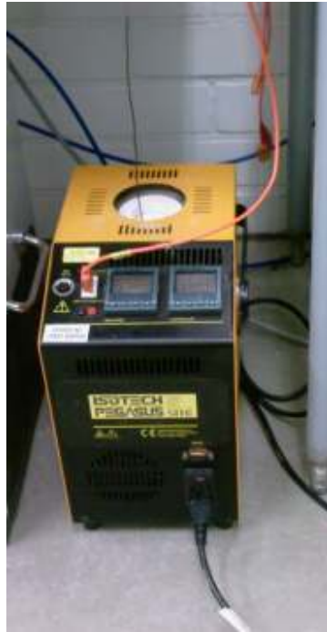
Şekil 3.9. Termokuplların kalibrasyonu için kullanılan referans fırını
