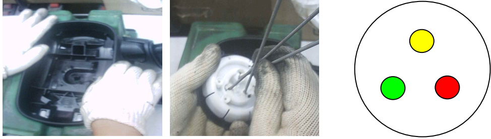
Şekil 4.5 Gövde-kol grubu+spiraller-mekanizma grubu montajı
