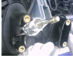
Şekil 4.13 Alt-üst körüklerin giydirilmesi
