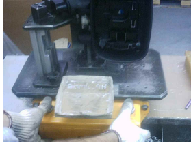
Şekil 4.4 Kol grubu çakma işlemi
