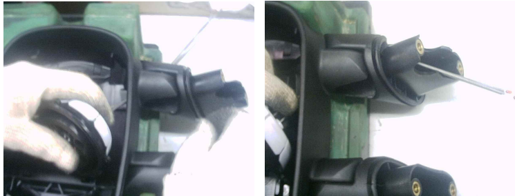
Şekil 4.6 Spiralli mekanizmanın kol içine montajı
