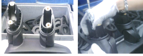
Şekil 4.11 Alt kol tapası montajı
