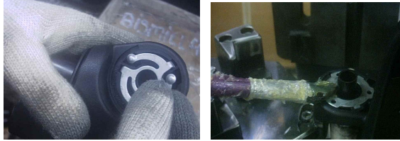
Şekil 4.2 Segman yayı montajı+gresleme
