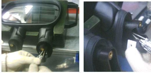
Şekil 4.16 Ayna camı hareket kontrolü
