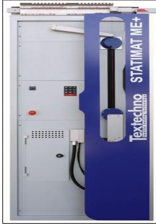
Şekil 3.5. Statimat Me+ İplik mukavemet test ölçüm cihazı
