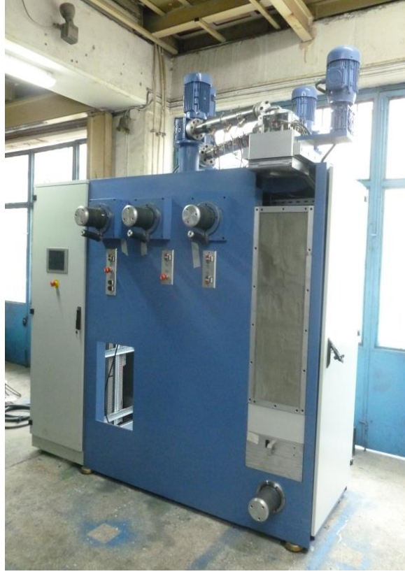
Şekil 3.3. Pilot bikomponent iplik üretim makinesi
