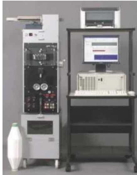
Şekil. 3.7. Evennes Tester 80 iplik düzensüzlük test ölçüm cihazı
