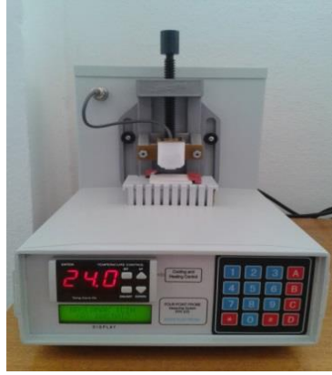
Şekil 3.8. 4 nokta prob elektrik iletkenlik ölçüm cihazı
