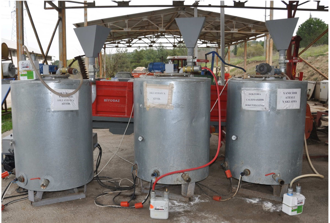
Şekil 3.5. 500 litre hacimli fermantörlerin modifiye edildikten sonraki hali
