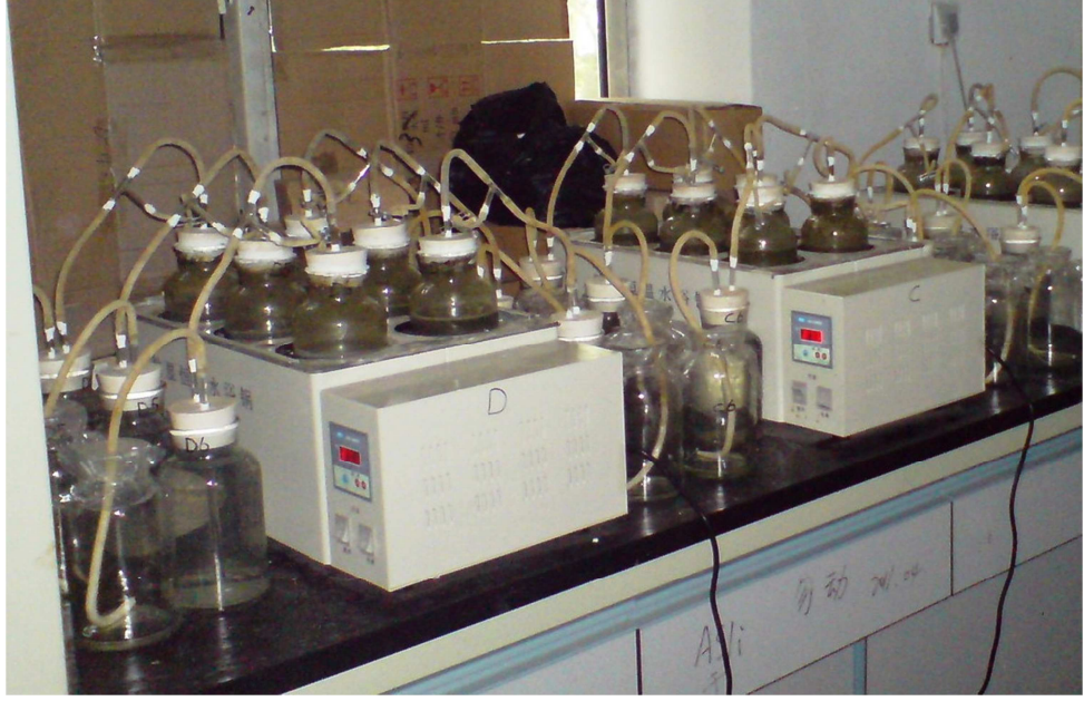
Őekil 3.3. Laboratuvar ölçekli anaerobik fermantasyon düzeneđi ve su banyosu
