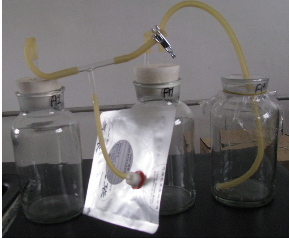
Şekil 3.1. Laboratuvar ölçekli anaerobik fermantasyon düzeneđi
