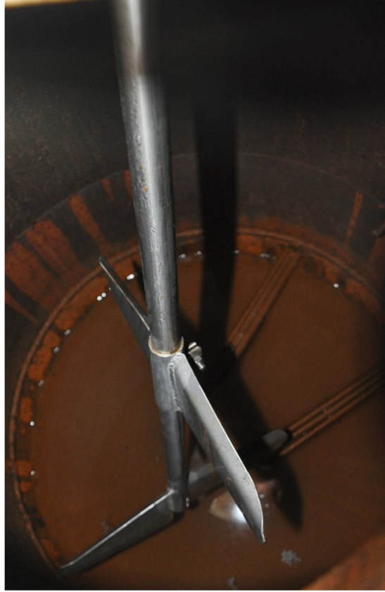
Şekil 3.6. Karıştırıcı mil ve kanatlar
