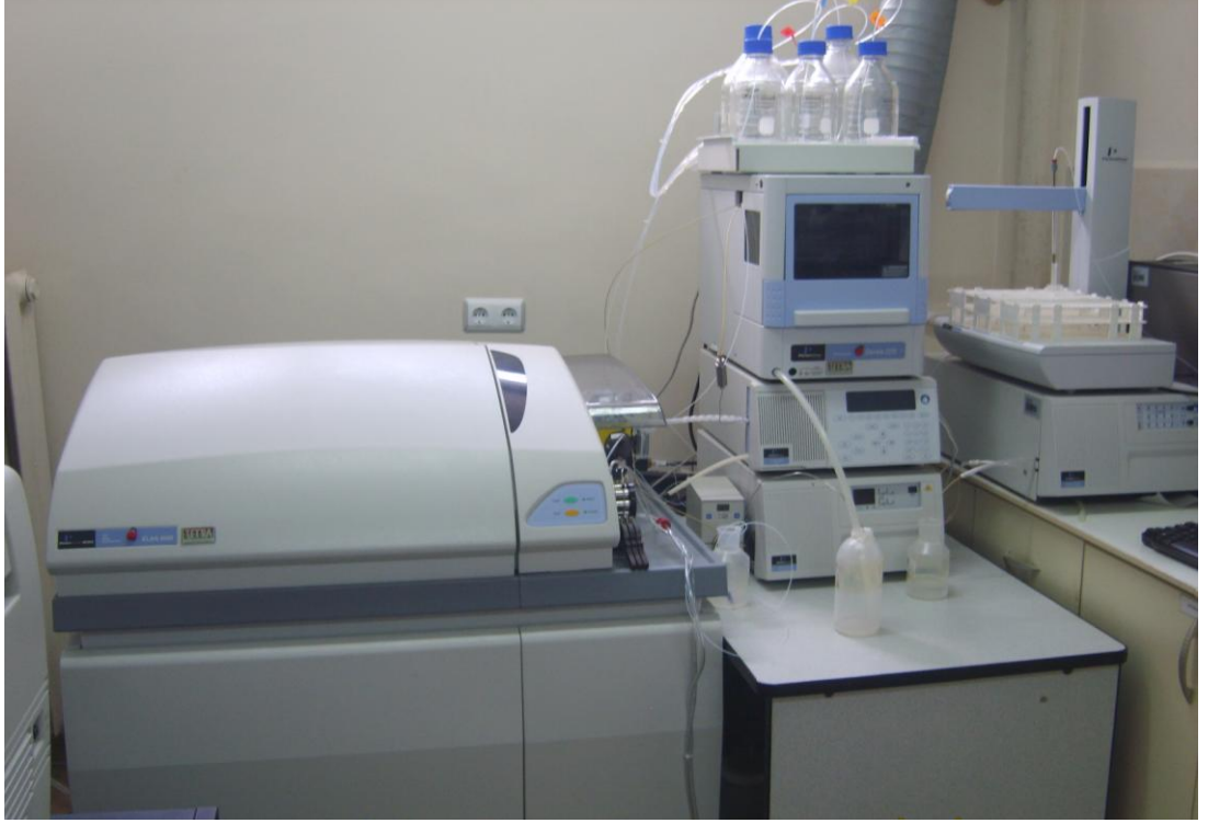
Şekil 1. HPLC-ICP-MS cihazı (ICP-MS solda, ve HPLC sağda)
