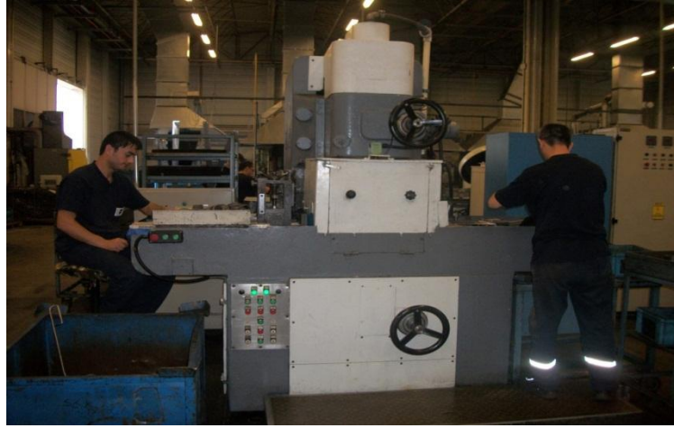
Şekil 4.15. İki operatörle çalışan kalınlık taşlama süreci
