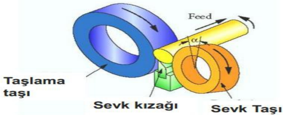
Şekil 4.19. Puntasız taşlama işlemi şematik gösterimi
