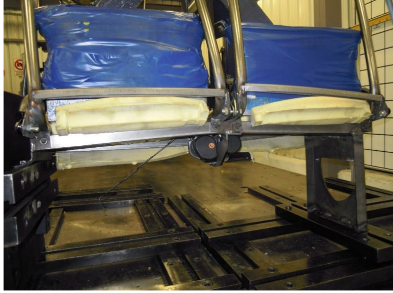
Şekil 4.19. Prototip koltuğun şasisinin test sonrası görüntüsü
