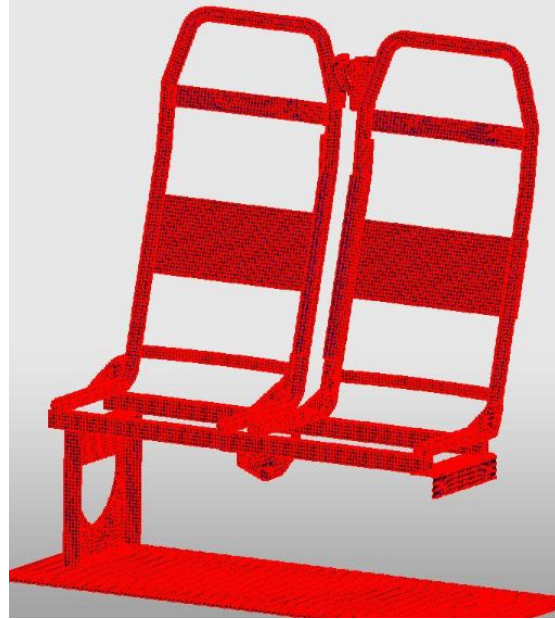
Şekil 3.16. Sonlu elemanlar modelinde contactların tanımlanması
