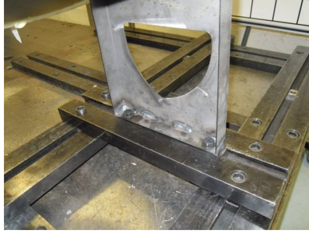
Şekil 4.17. Prototip koltuğun ayağının test sonrası görüntüsü
