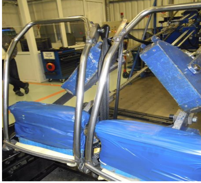
Şekil 4.21. Prototip koltuğun arkalık iskeletoninin test sonrası görüntüsü
