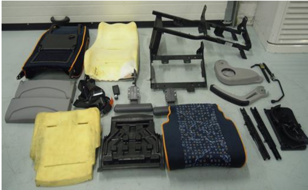
Şekil 3.6. Yolcu koltuğunun temel parçaları
