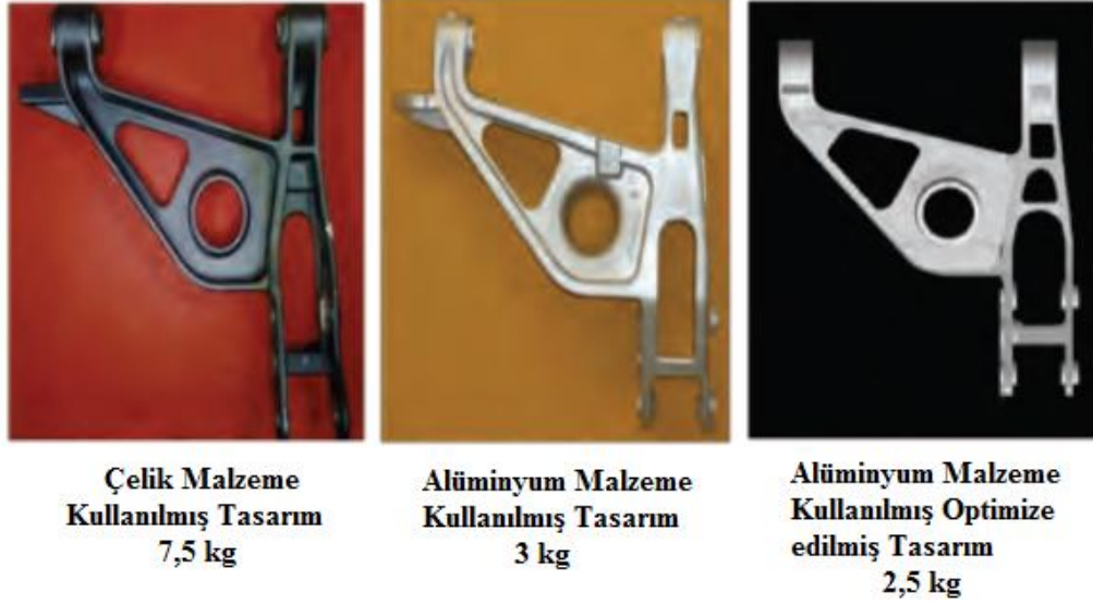
Şekil 2.15. Optimizasyon tekniği ile parçanın hafifletilmesi (U.S Department of Energy, 2010)
