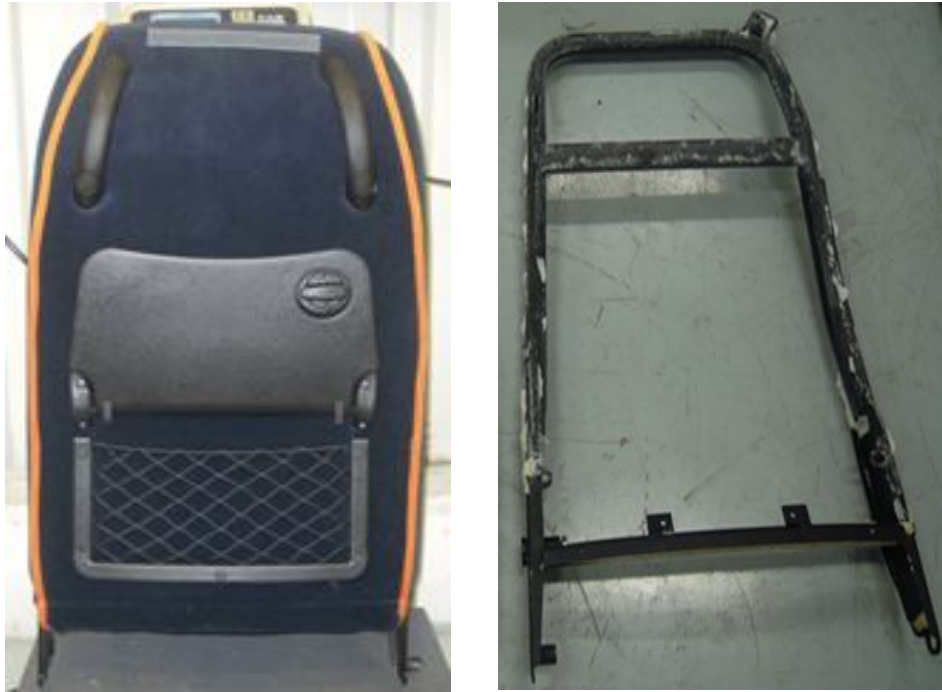
Şekil 3.4. Koltuk arkalık yapısı ve iç iskeleti
