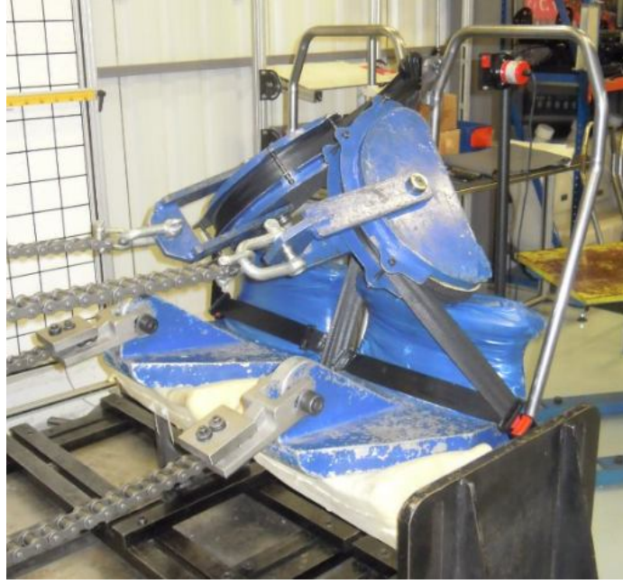
Şekil 4.15. Prototip koltuğun ECE R14 test görüntüsü
