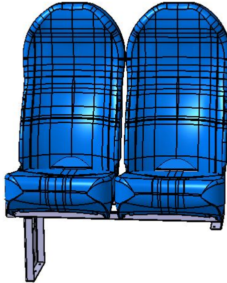
Şekil 4.1. Hafifletilmiş yolcu koltuğunun final tasarımı
