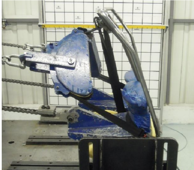
Şekil 4.22. Prototip koltuğun test sonrası görüntüsü
