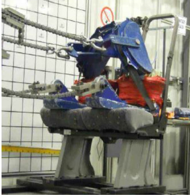
řekil 3.10. Emniyet kemer ekme testi dzeneėi
