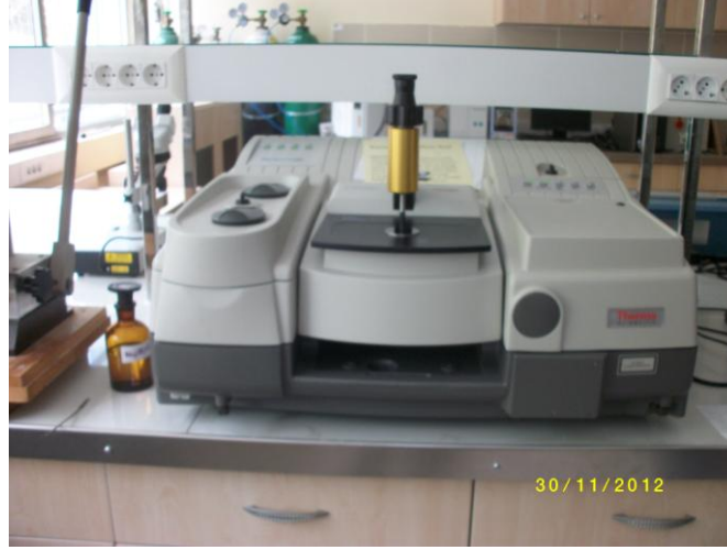
Şekil 4.17. Ölçümlerin yapıldığı Thermonicolet FT-IR-6700 spektrometresi.
