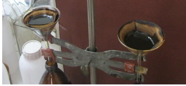
Şekil 3.3. Asfalt süzdürme işlemi
