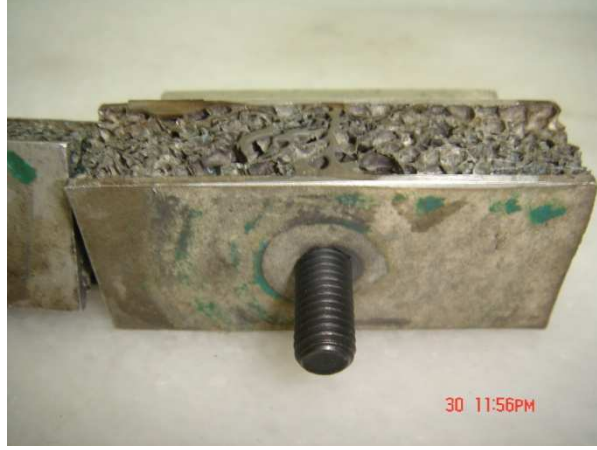
Şekil 2.22 - Çekme Deneyi Öncesi Al. Plaka Kaynaklı ve Saplama Montajlı Numune
