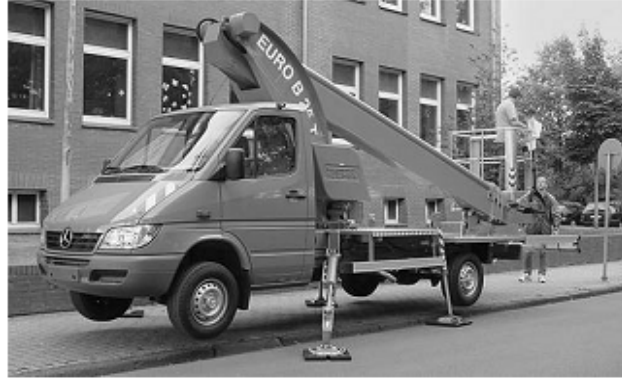
Şekil 1.4 - “EURO B25T” Köpük Metal Takviyeli Karma Kolu Desteği (Banhart 2008)
