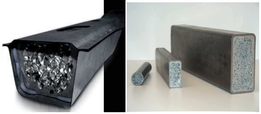
Şekil 1.3 - İçi Köpük Metal ile Doldurulmuş Profil (Hanssen 2003)
