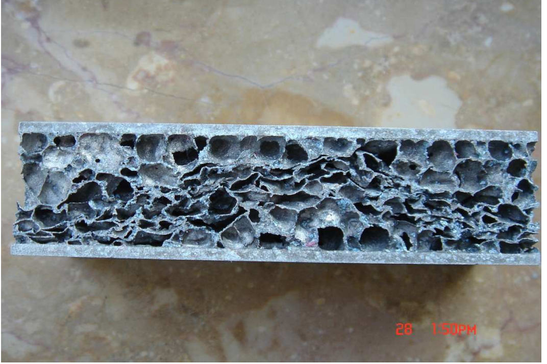
řekil 2.9.- Tel Erozyonla Kesim Sonucu (Sandviç Yapılı Malzeme)
