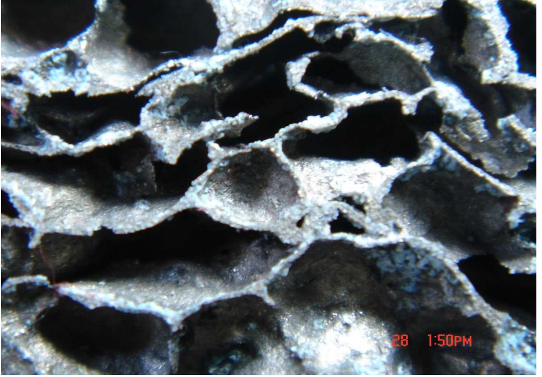
Şekil 2.10 - Tel Erozyonla Kesim Sonucu Oluşan Yapı (Sandviç Yapılı Malzeme)
