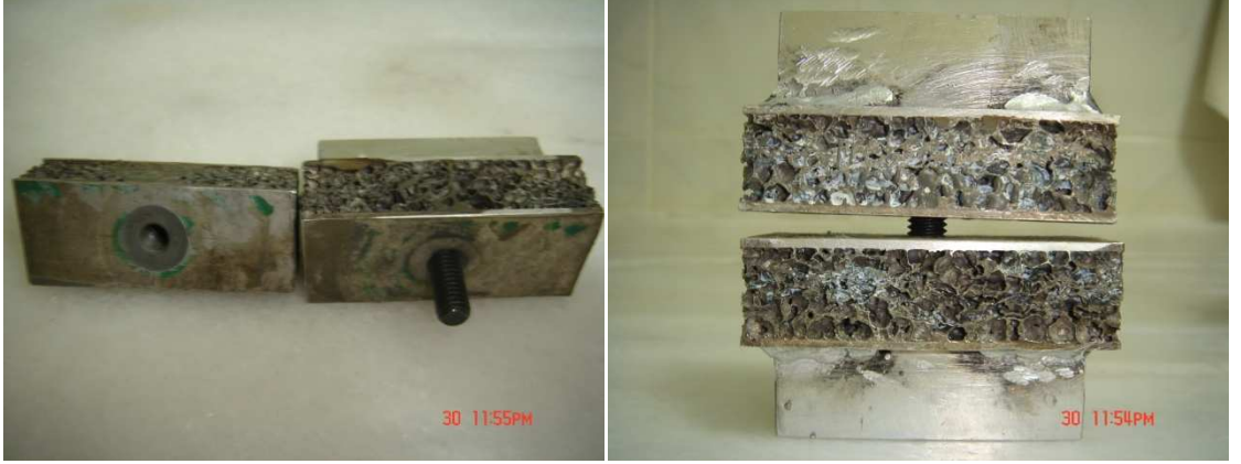
Őekil 2.19. -  ekme Deneyi  ncesi DiŐ A ılmıŐ K p k Malzeme
