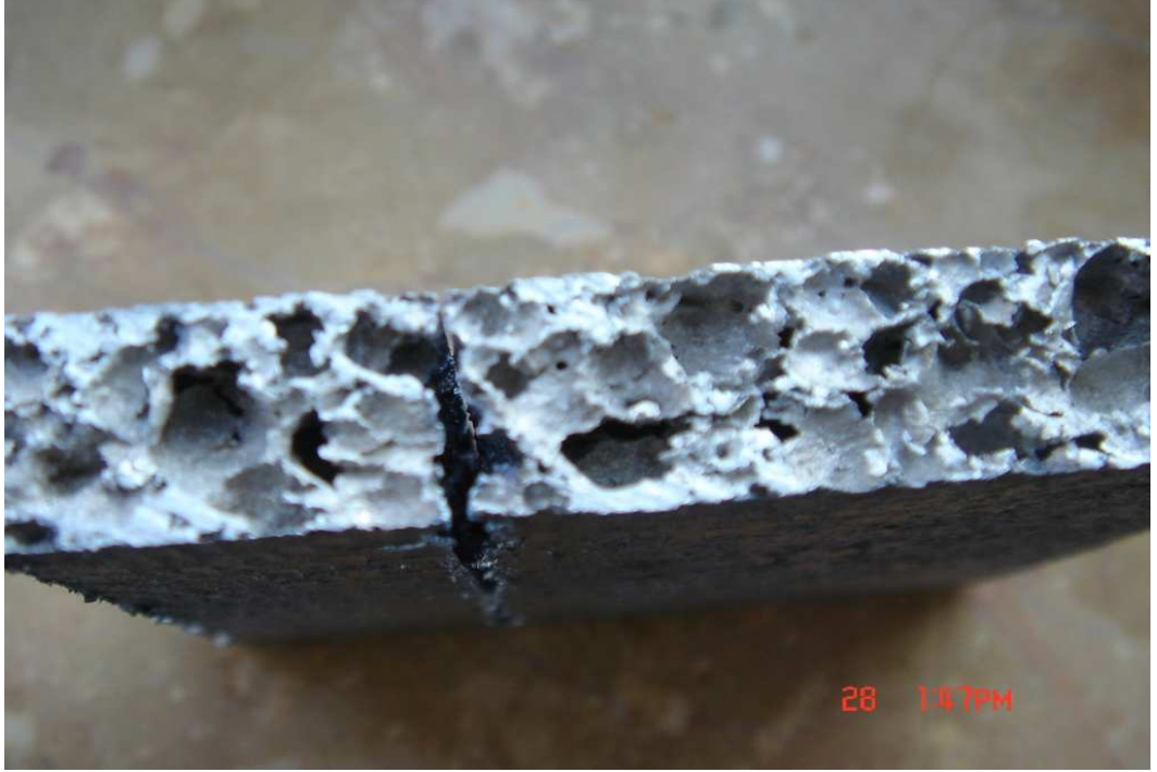
Şekil 2.2. - Lazerle Kesim Sonucu ( Kesim 1)
