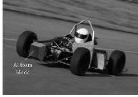
Şekil 1.7 - Almanya Stralsund Teknoloji Üniversitesi Tarafından Üretilen Model Yarış Araba Üzerinde Darbe Koruyucu Olarak Köpük Kullanımı (Lefebvre 2008)
