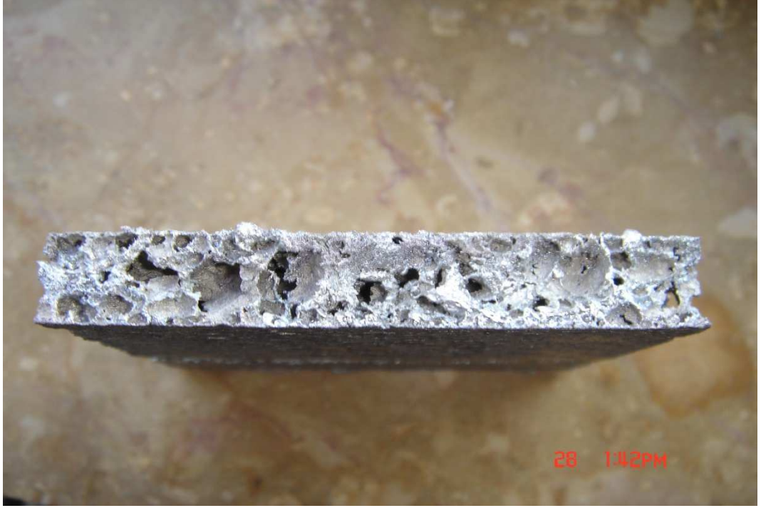
Şekil 2.6. - Lazerle Kesim Sonucu ( Kesim 3)
