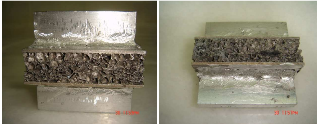
Şekil 2.15 - Çekme Deneyi Öncesi Alüminyum Plaka Kaynatılmış Köpük Malzeme
