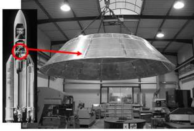
Şekil 1.5 - Sandviç Köpük Panelden (AFS) Yapılmış Ariane5 Roket Konisi (Banhart 2008)
