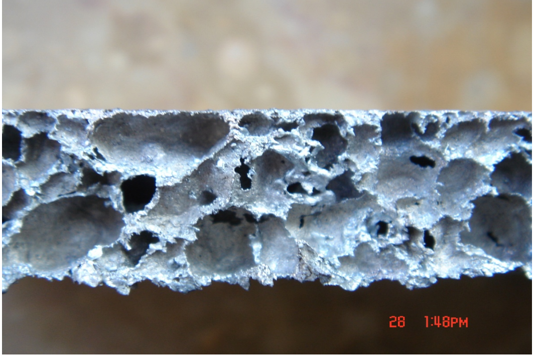
Şekil 2.4. - Lazerle Kesim Sonucu ( Kesim 2)
