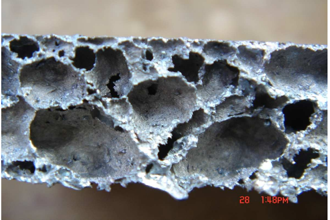
Şekil 2.5. - Lazerle Kesim Sonucu (Lazer Kesim 2.1)
