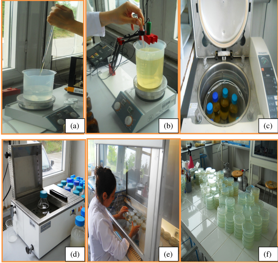
Şekil 3.3. Besi ortamlarının hazırlanması, (a) Isıtıcı karıştırıcı üzerinde besli ortamlarının hazırlanması, (b) pH metre ile ortam pH'sının 5.7'ye ayarlanması, (c) Besli ortamlarının otoklavda sterilizasyonu (d) Besli ortamlarının 50 °C sıcaklıkta su banyosunda 2-3 saat bırakılması, (e) Besli ortamlarının petri kaplarına aktarılması (f) Petri kaplarına aktarılmış denemede hemen kullanılacak olan besli ortamları
