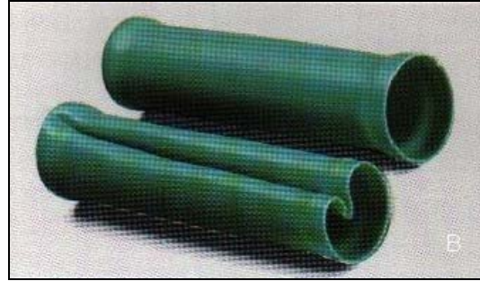
Şekil 2.10. Fikse işlemi, ipliğin kendi üzerine sarılması engeller(A) ve ipliğin üzerine sarılacağı malzemeye zarar vermez(B)(Anonim 2003, 2004, 2005 b)
