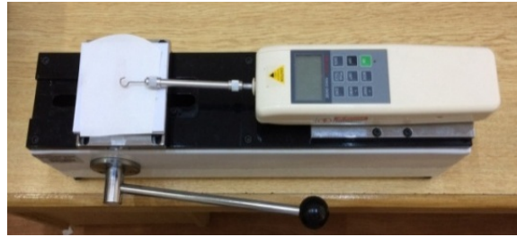
Şekil 2. Dinamik sürtünme katsayısının belirlenmesinde kullanılan düzenek
