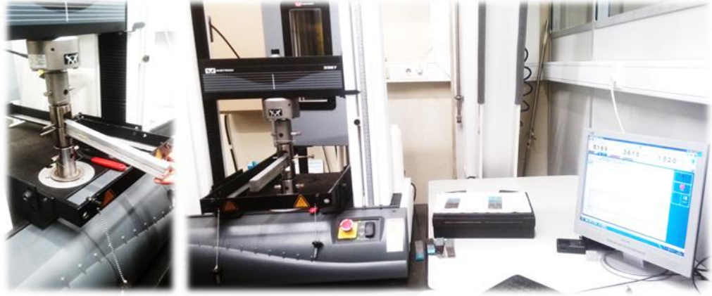
Şekil 6.26. INSTRON üniversal çekme makinesinde DCB testi
