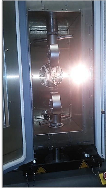
Şekil 6.22. INSTRON üniversal makinesinde SLJ testi
