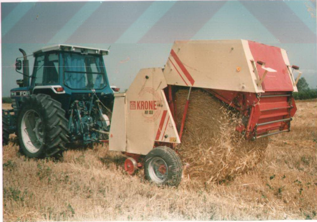
Şekil 6. KR 155 Silindirik Balya Makinasının Tarla Çalışmasından Bir Görünüş
