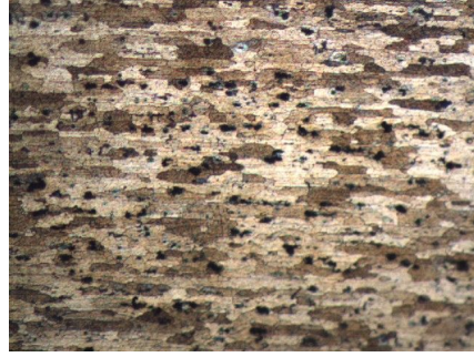
Şekil 3.10 2014 Serisi Alüminyum Alaşımının Mikroyapısı X100
