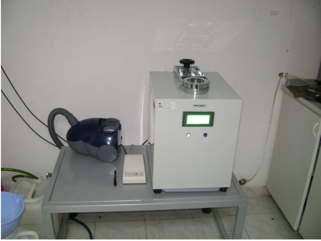
Şekil 3.5. Branca hava geçirgenliği ölçüm cihazı
