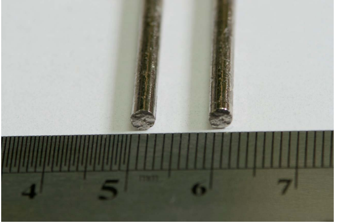
Şekil 3.3 Vakumla döküm metodu ile üretilen çubuklar
