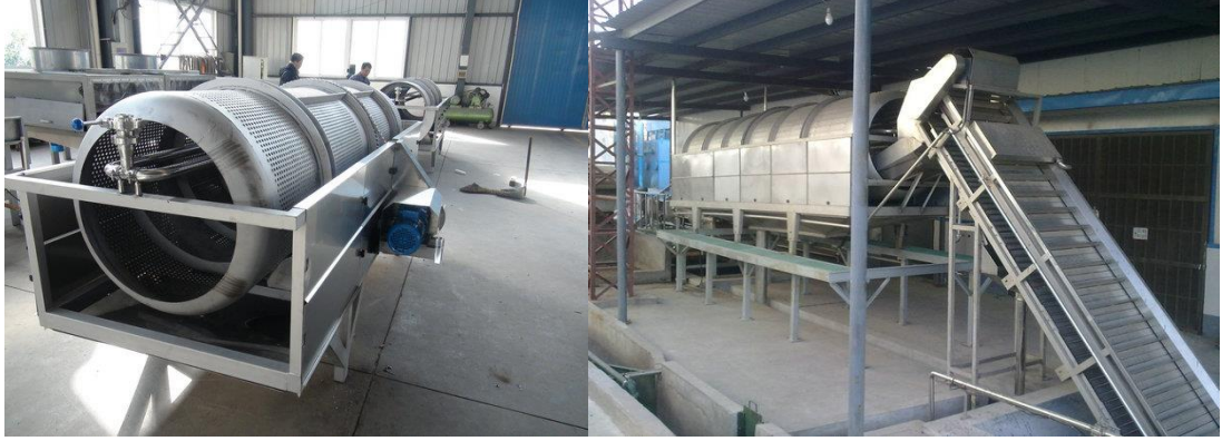
Şekil 3.3. Tamburlu meyve sebze yıkama makinesine bir örneğin önden ve yandan görünüşleri (Anonim 2004b).
