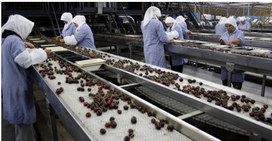
Şekil 3.5. Ayıklama bandı örneği ve ayıklama personelinin yerleşimleri (Kiraz) (Anonim 2008).
