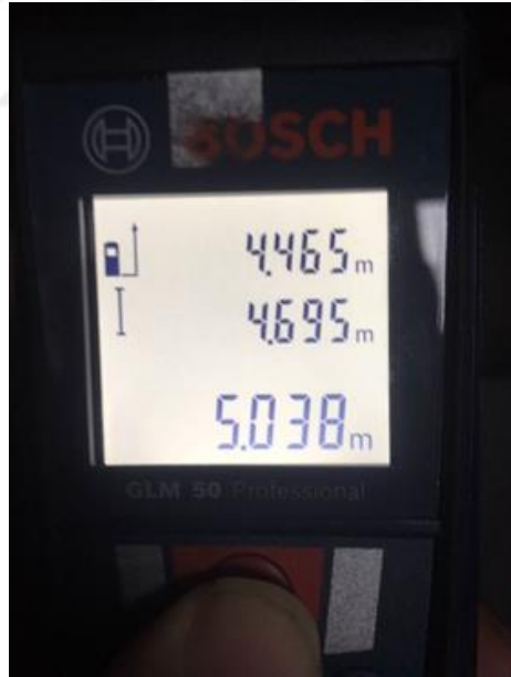
Şekil 3.15. Lazer metre ile atış mesafesinin ayarlanması
