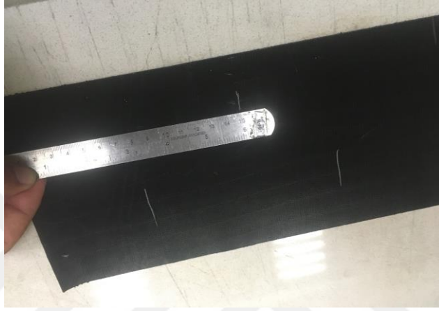
Şekil 3.18. Kord iplerinin istenen ölçüde hazırlanması
