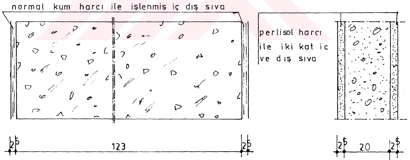
Şekil-14 Perlit Sıvaları ile Malzeme Cinsine Göre Kazanılan Duvar Kalınlıkları
