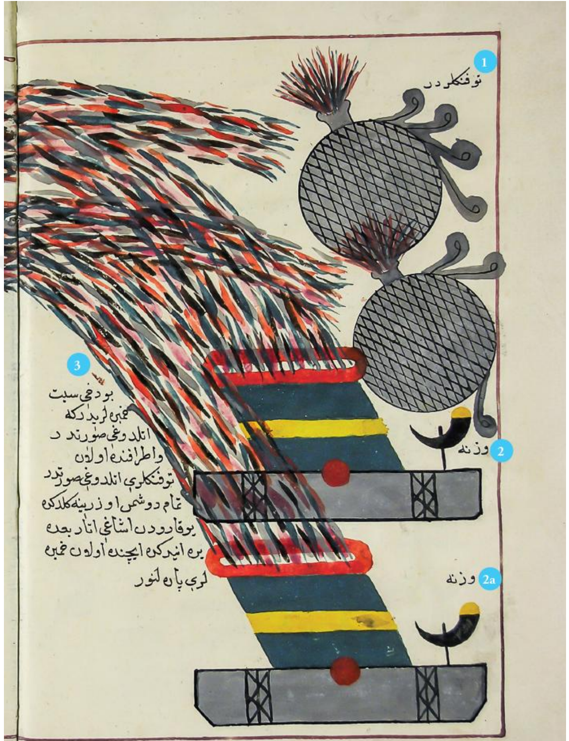
(1) 1: tüfenglerdür (2) 2, 2a: vezne (3) 3: bu dağı sepet humbaralarıdır ki atıldığı şüretdür ve etrafında olan tüfengleri atduğu şüretdür tamām düşmen üzerine geldükde yuqarudan aşığı atar ba' dehu yere indükde içinde olan humbaraları pärelenür
