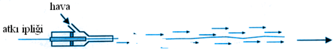
Şekil 1.8. Hava jetli atkı atma sisteminin şematik görünüşü (Adanur 2001)
