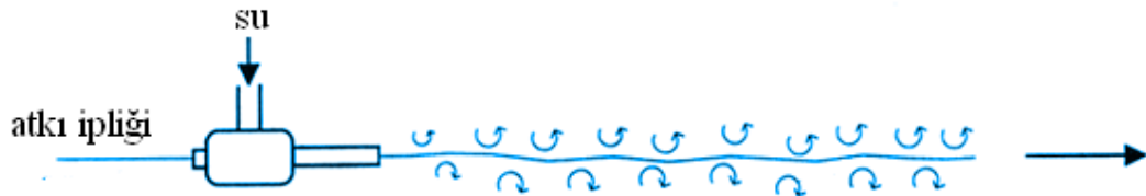
Şekil 1.9. Su jetli atkı atma sisteminin şematik görünüşü (Adanur 2001)
