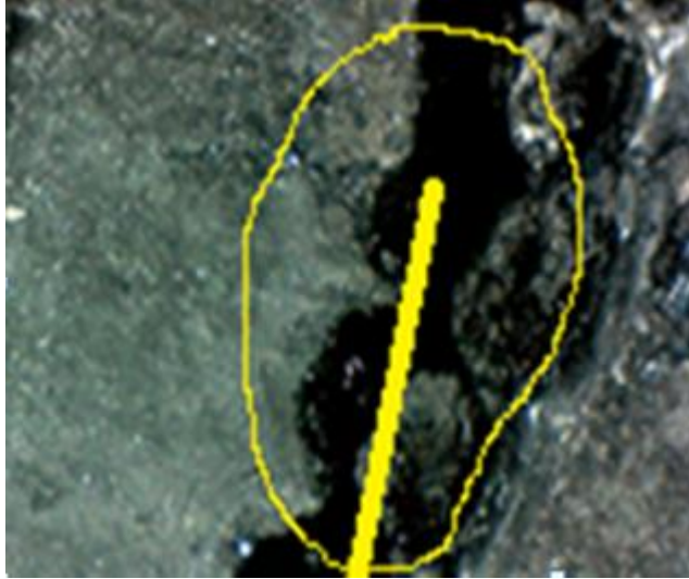
Şekil 2.15. Kauçuk-Kord bezi arası yorulma
