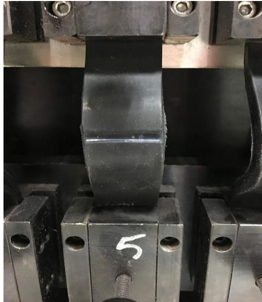
Şekil 3.5. De Mattia test cihazına numunenin bağlanması
