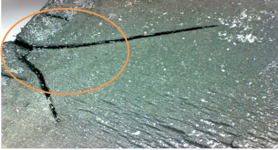
Şekil 4.12. Çatlak başlangıcı gerçekleşen numune örneği
