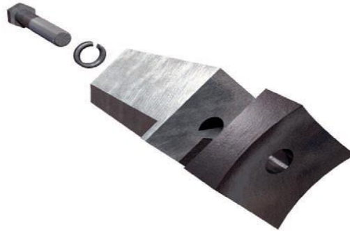
Şekil 2. 19. Kırıcı bıçak rotor montajı örneği
