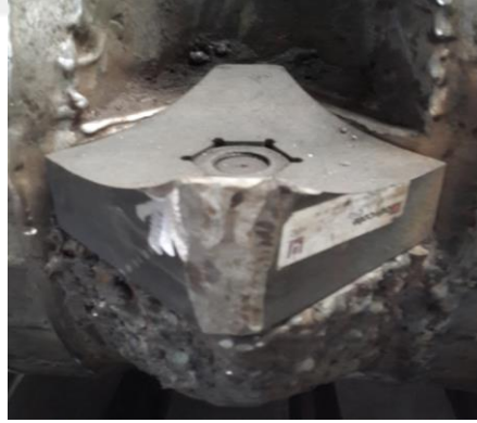
Şekil 2. 30. Bir ATY tesisinde kullanılan bir kesme bıçağına ait aşınma görünümü
