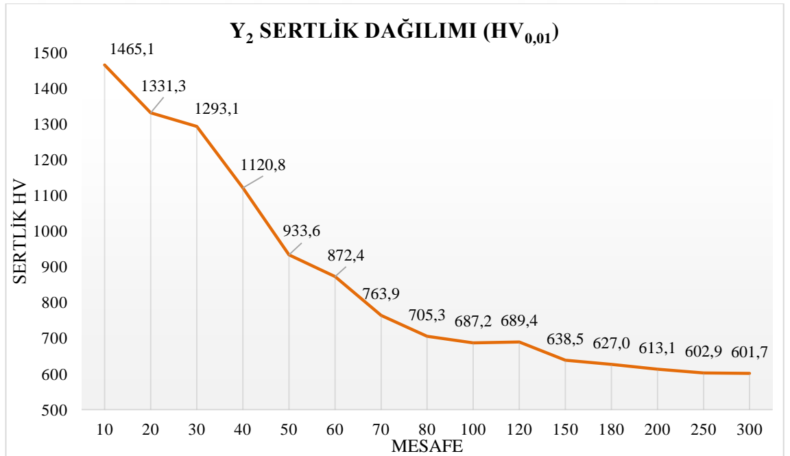
Şekil 4. 19. YKB-Y 2 Numunesi sertlik (HV 0,01 ) grafiği
