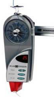
Şekil 3.4. Memminger Iro marka EFS 620 model elastan iplik besleyici
