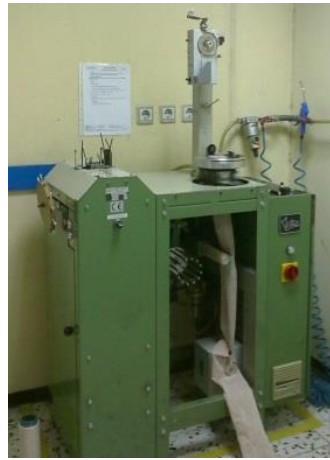
Şekil 3.2. E20 incelikteki, 3½” çap ve 220 iğneye sahip Harry Lucas marka yuvarlak örme makinesi
