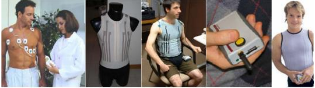
Şekil 2.37. Wealthy elektronik giysi sistemi ile hastaların sağlık kontrolünün hastane dışından da online olarak izlenebilmesi (Paradiso 2006)
