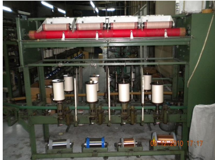
Şekil 3.1. Metal tel ve pamuk ipliklerin oyuk iş yöntemiyle bükülmesi
