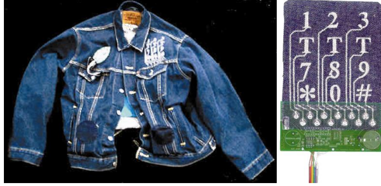
Şekil 2.39. Nakış işlemi ile e-tekstillerin üretimi (Post ve ark. 2000)
